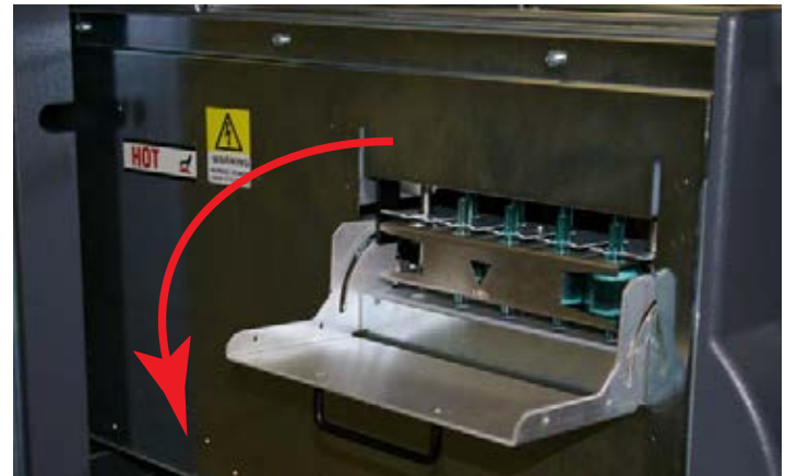
Pyrolyzer Filter Door
